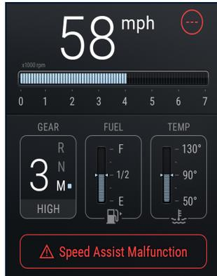
Liegt eine Fehlfunktion oder ein Fehler jeglicher Art im ISA-System vor, wird der Fahrer durch eine optische Warnung auf dem Infotainment-Bildschirm und die darauf folgende orange
