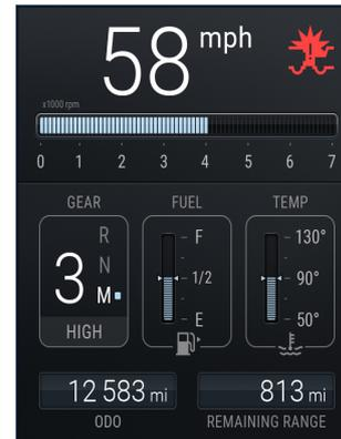
Der FCW bleibt aktiv, bis der AEB-Vorgang abgeschlossen ist. FCW und AEB werden abgebrochen, wenn der Fahrer stark lenkt, beschleunigt oder das Bremspedal betätigt und wieder loslässt.
