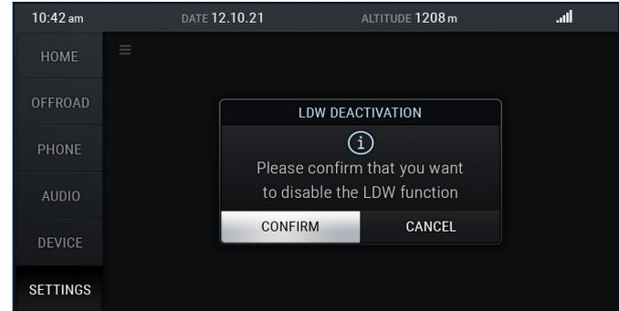
Das System schaltet unter bestimmten Umständen automatisch ab, z. B. wenn Off-road-/Wading Mode (Offroad-Modus oder Watmodus) und/oder die Differenzialsperre aktiv sind. Das System wird automatisch wieder aktiv, sobald die Bedingungen, die zum automatischen Ausschalten geführt haben, nicht mehr vorliegen.
