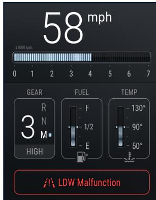
Liegt eine Fehlfunktion oder ein Fehler im System vor, ist die Option Spurhaltewarnsystem ausgegraut.
